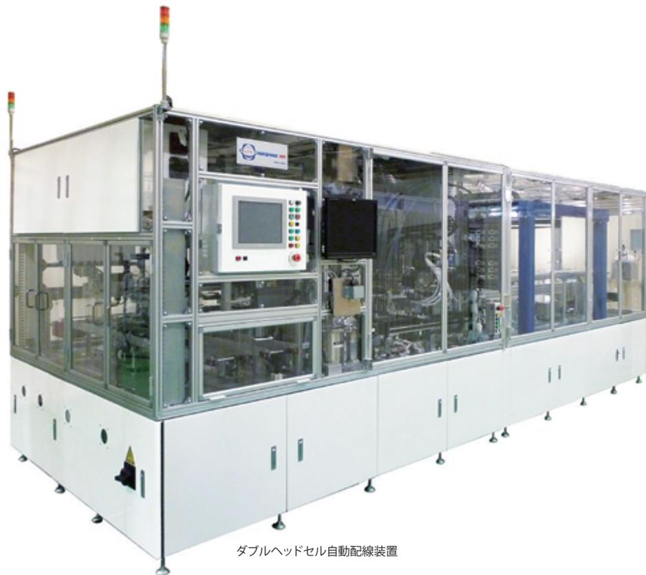
ダブルヘッドセル自動配線装置
